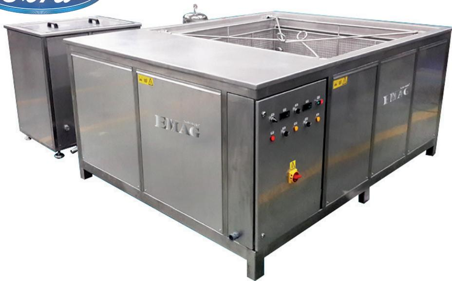
Unité de dégraissage ultrasonore pour pièces de carrosserie développée par EMAG AG pour le fabricant automobile FORD.
