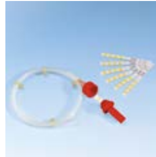
ZS 150-1 Test Helix Contrôle des process du stérilisateur dentaire avec un indicateur chimique grâce au contrôle de pénétration de vapeur. Affichage des résultats par changement de couleurs 1 dispositif, 250 indicateurs
