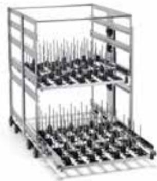
L'injection des supports peut être placée sur les différents niveaux du panier CLB510 respectant les hauteurs et le volume de lavage de verrerie. Le support peut être retiré de l'élément télescopique pour faciliter le chargement d'objets en verre.
